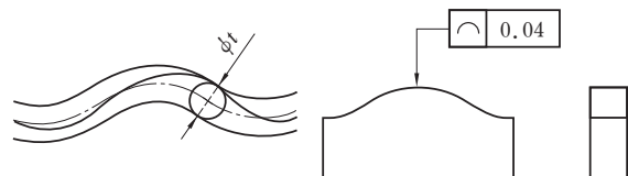
그림 I-137 단독 형체의 선의 윤곽도 공차역의 정의 및 도시 예
